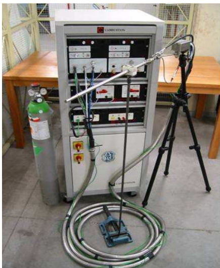
Σχήμα 6. Ο ειδικός δειγματολήπτης NOx τοποθετημένος στον αυλό εξαγωγής της μηχανής και το σύστημα δειγματοληψίας Cambustion
