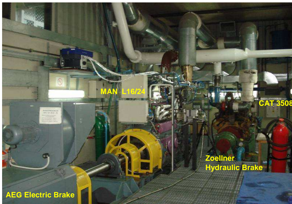
Σχήμα 5. Οι δυο τετράχρονοι κινητήρες Diesel με τα αντίστοιχα δυναμόμετρα τους
